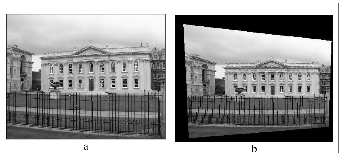
Figura 2.5 Rettificazione basata su un piano di riferimento: (a) la facciata presente nell'immagine costituisce la struttura planare di riferimento adoperata per la rettificazione; (b) risultato dell'operazione di rettificazione, con il piano dell'immagine parallelo alla struttura planare di riferimento.
